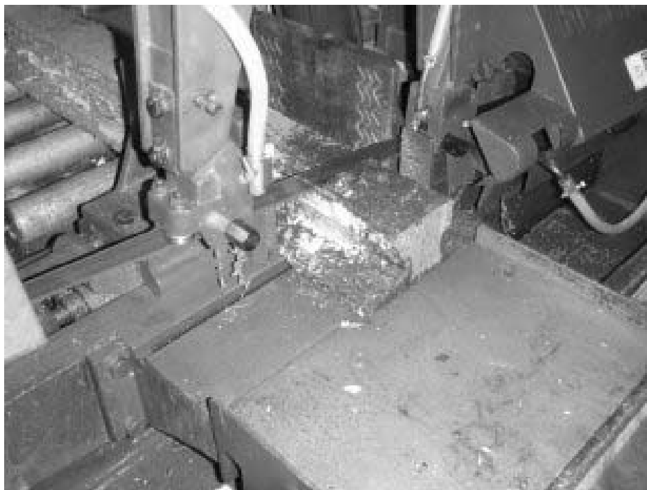
図 3.4.2-5 大型バンドソーによる解体作業
