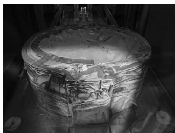
廃棄物②の圧縮状況
